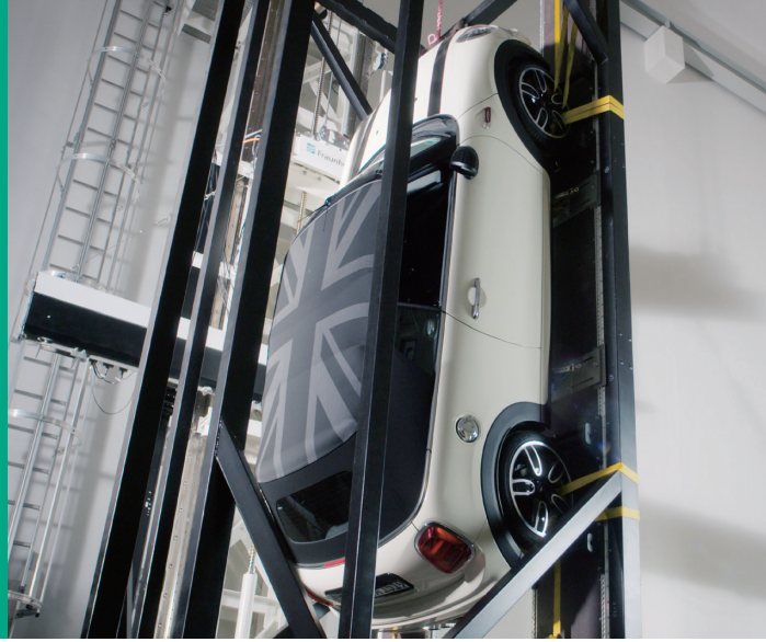
産業用大型X線CT装置 XXL-CT (© Fraunhofer EZRT)
